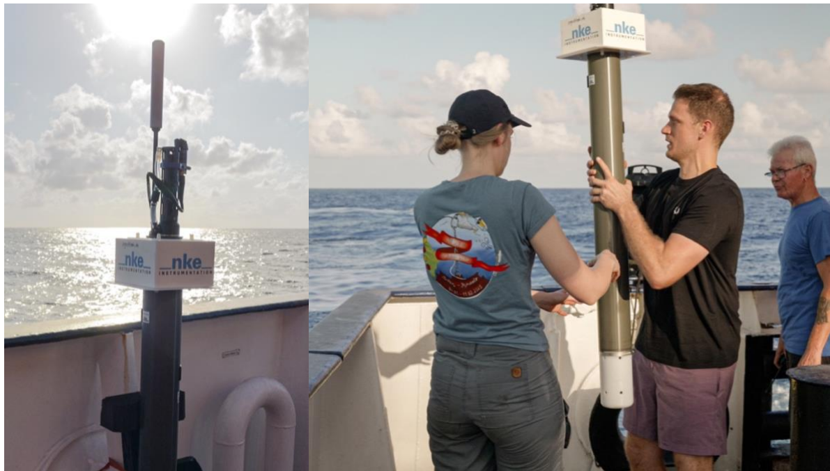
Abb.4: Links: Argo Float mit Temperatur, Salzgehalts -und Sauerstoffsensoren. Ganz oben ist die weiße Antenne zu erkennen. Rechts: Argo Float bei der Auslegung über das Heck von FS Meteor. Fotos: David Menzel.
