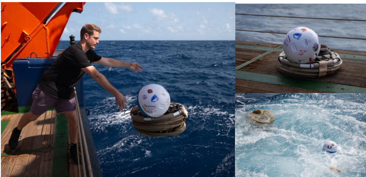
Abb.3: Auslegung eines SVP Oberflächendrifiers über das Heck von Meteor. Fotos: David Menzel.
