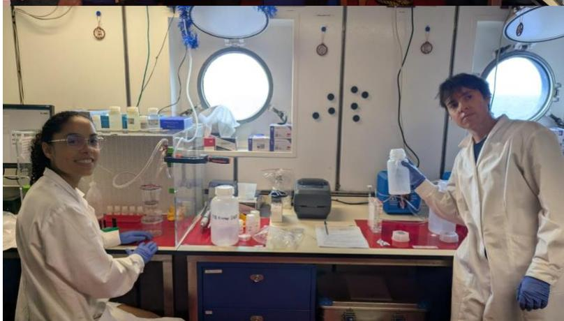
Abb. 2b: Labor für die Filtration der Wasserproben zur späteren Spurenmetall-Analyse in verschiedenen Größenfraktionen zwischen echt gelöst und partikulär: Sequentielle Filtration durch Membranfilter (Caitlyn Kelly, links) und Ultrafiltration (Adrian Hollister, rechts).
