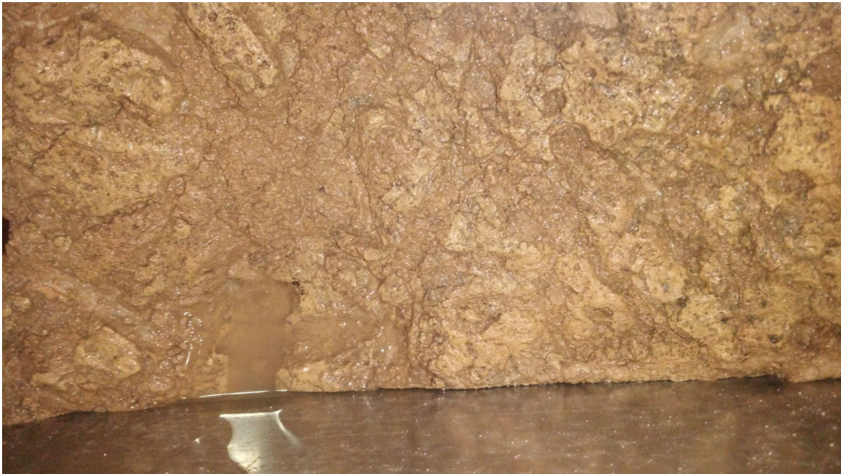
Abbildung 3. Ausschnitt einer ca. 20 cm unter der Sedimentoberfläche gelegenen Schicht verfestigten Sediments im Großkastengreifer (GKG) SA4-A4. Foto: Andreas Gaertner, SGN.
