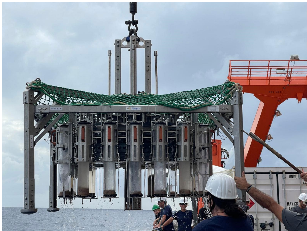
Abbildung 5. Der 20-Kern-Multicorer der RUBBLE-Expedition, der 205. Forschungsreise der FS METEOR. Die Plastikröhren sind nach dem Einsatz SA5-B4 zwar verschlossen aber enthalten kaum bis kein Sediment. Foto: Angelika Brandt, SGN.
