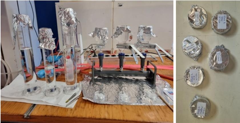
**Abbildung 6.** Glasmesszylinder und Aluminiumverpackungen für die Sammlung und Lagerung von Mikroplastikproben. Fotos: Leda Cai (CMMI).
