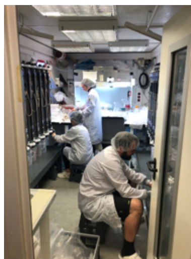
Abbildung 1. Links: Probenahme zur Bestimmung von Spurenmetallkonzentrationen im Meerwasser mit einer CTD mit Titanrahmen und Winde mit Kevlarkabel (gelb). Rechts: Probenahme aus den CTD-Flaschen für Spurenmetalle in einem speziellen Probenahmecontainer (weißer Container am Heck des Schiffes auf dem Foto links).
