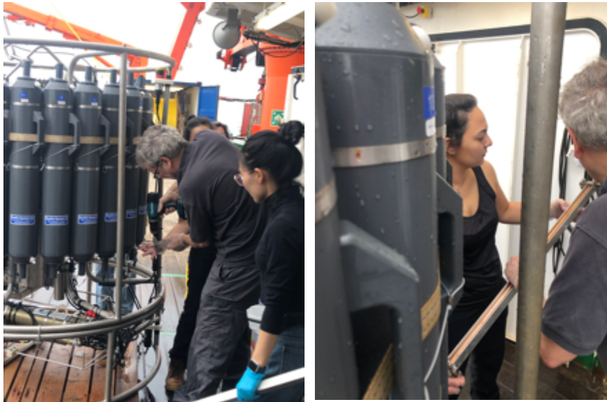
Abbildung 2. Entnahme von Proben für die Helium-3-Analyse in Kupferrohren an der Napoli Schlammvulkanstation.
