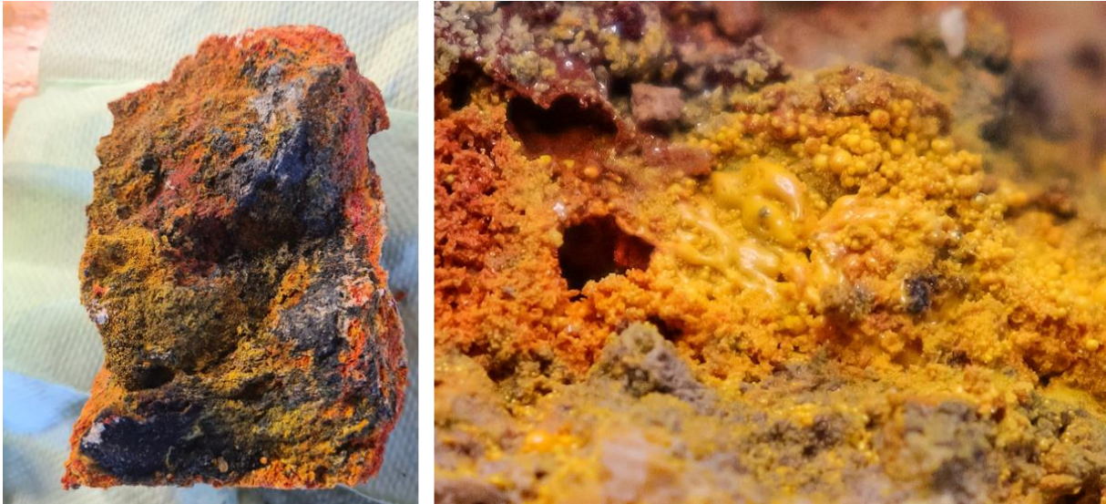
Abbildung 2: Schlotstruktur mit Arsen- und Antimonsulfiden (Foto: rechts: Solveig Bühring, links: Palash Kumawat)
