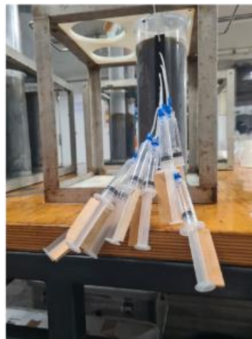
Abbildung 1: Der Multicorer kommt zurück an Deck (links), Kernrohre aus dem Multicorer (rechts oben), Beprobung des Porenwassers mit Rhizonen (rechts unten) (Fotos: Solveig Bühring)
