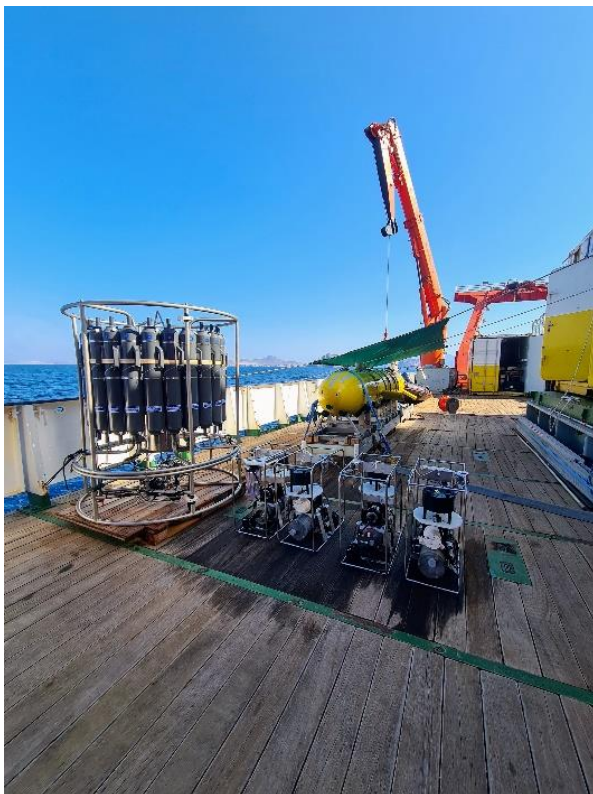
Abbildung 1: Haupteinsatzgeräte in dieser Woche: links CTD-Wasserschöpferrosette, rechts in-situ Pumpen und dahinter das AUV MARUM-SEAL unter seinem Sonnenschutzsegel
