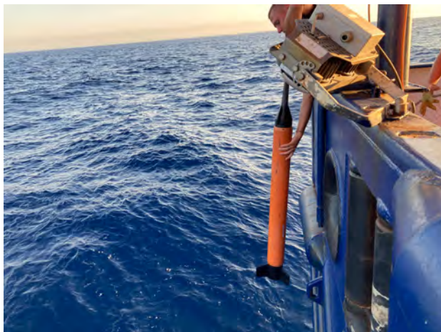
Abb. 1: Nach dem Aufspulen des 300 m langen Kabels wird der Magnetometer-"Fisch" zum letzten Mal eingeholt. Die Stärke und Form der aufgezeichneten magnetischen Anomalien geben Aufschluss über die Tiefe und die Zusammensetzung der magnetischen Quellen (z.B. magmatische Körper) in der Kruste. Foto: J.G.
