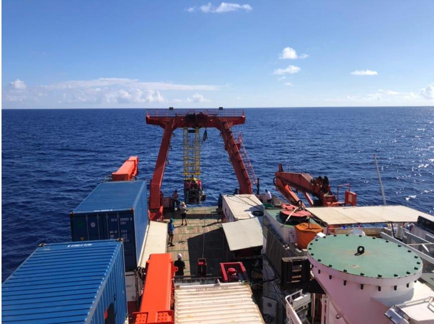
*Abb. 3: Der Tauchroboter MARUM QUEST 4000 wird über den A-Rahmen des FS Meteor ausgesetzt. Selbst bei bestem Wetter und ruhiger See verlangt dieser Vorgang höchste Konzentration von Brücke, Deck und ROV-Team. Foto: Christian Ostertag-Henning*
