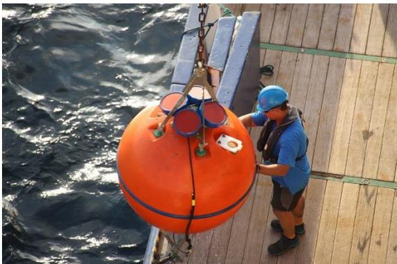
Abb. 1: Aufnahme des akustischen Doppler Strömungsprofilers auf 11°S, der dort seit April 2022 in 500m Wassertiefe verankert war.
