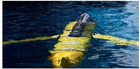
Glider während des Tests der Ballastierung (Fotos: C. Mertens).
