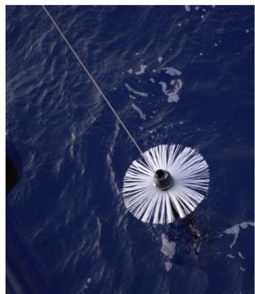
*Abb. 2: Erster Einsatz der freifallenden Mikrostruktursonde zur Turbulenzmessung im oberen Ozean.*
