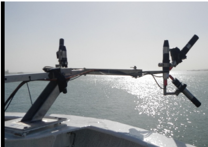
Abb. 3: Radiometer zur Messung der optischen Eigenschaften des Ozeans an der Vorderseite des RV Meteor. Foto: Shungu Garaba.
