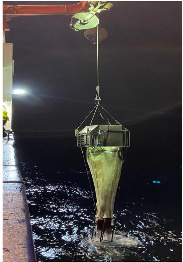
Rechts: Vertikal geschleppter Multiple Plankton Sampler (Multinet).
