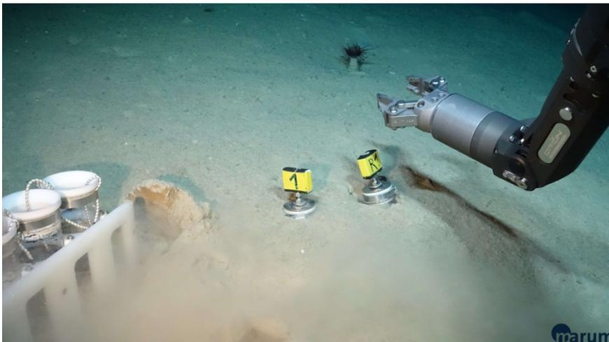
*Abb. 5: Der Tauchroboter MARUM SQUID nimmt in ca. 1600 m Wassertiefe Sedimentproben mit Push Corer.*
