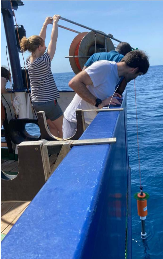
**Abb. 2:** Einsatz des Mikrostruktur-Messsystems (Foto: Peter Brandt).
