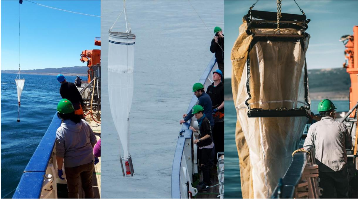
Abb.4: Die auf der FjordFlux eingesetzten Planktonnetze: ein Phytoplanktonnetz mit einer Maschenweite von 20  $\mu\text{m}$  (links), ein Mesozooplanktonnetz mit einer Maschenweite von 200  $\mu\text{m}$  (Mitte) und ein Tucker Netz für grösseres Zooplankton mit einer Maschenweite von 300  $\mu\text{m}$  (rechts).
