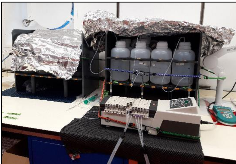
Abb.1: Filtrationsanlage zur Gewinnung der empfindlichen Vitaminproben
