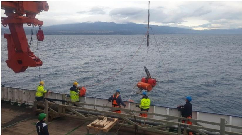
*Foto 1: Das Aussetzen einer marinen Geodäsie-Station vor Ätna (Foto: Alessandro Bonforte)*
