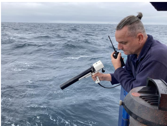
Abb. 1: Der Lt. Elektroniker Olaf Willms der METEOR beim manuellen Aussetzen der XSV-Sonde zur Messung des Wasserschallprofils. Die Sonde sinkt im freien Fall durch den Wasserkörper, zeichnet dabei die Wasserschallgeschwindigkeit kontinuierlich auf und schickt die Daten durch einen dünnen Draht zum Schiff, wo sie prozessiert werden. Foto: J.G.
