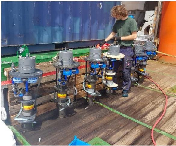
Abb. 1: In situ Pumpen an Deck nach einem Einsatz bei ca. 2100 m. Foto EA
