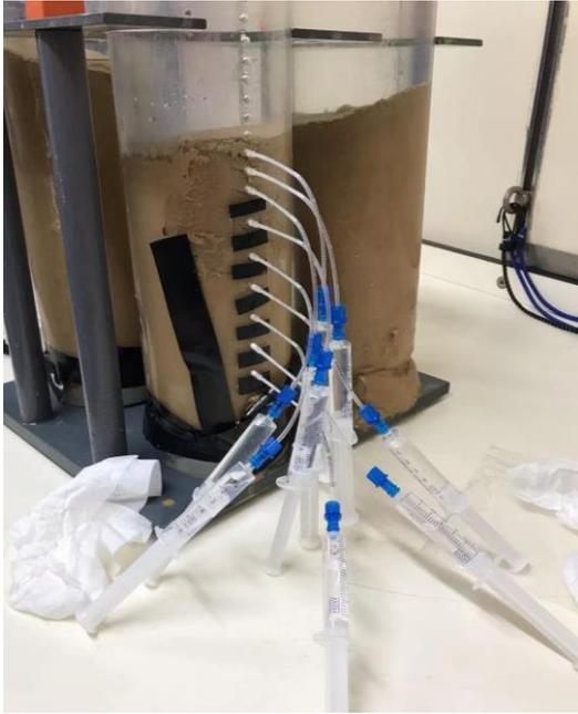
*Abb. 2: Porenwasserbeprobung an Sedimentkernen unter Rainbow Plume (ca. 2.300 m). Foto Zhouling Zhang*
