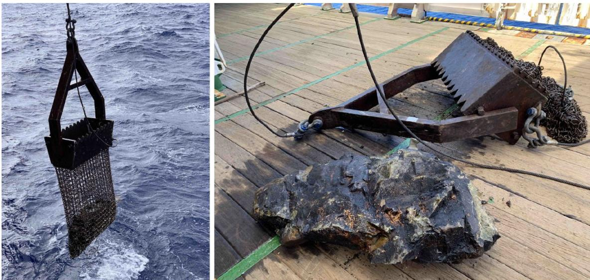
**Abb. 1.** Kettensachdredge mit geborgenen Gesteinen vom Meeresboden, und die größte Gesteinsprobe der Reise am Deck des FS METEOR.
