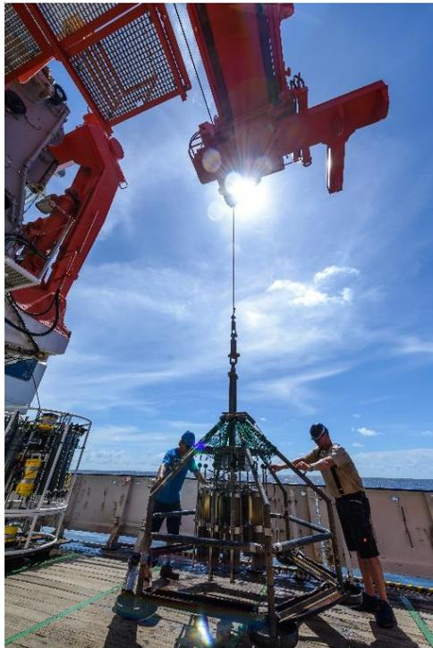
*Multicorer, der gerade mit 8 Kernen beladen wieder an Deck gestellt wird.
