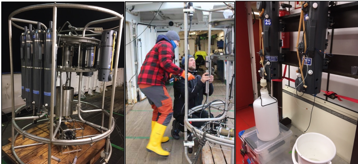
Foto links: CTD-Kranzwasserschöpfer, unser Haupt-Arbeitsgerät; Mitte: David Ernst und Dennis Krämer bereiten die CTD für den nächsten Einsatz vor; Rechts: Die spurenmetallreinen GoFlo-Flaschen im Labor zur Entnahme der Wasserproben. (Fotos von Adrienne Hollister (links, rechts) und Franziska Klimpel (Mitte))
