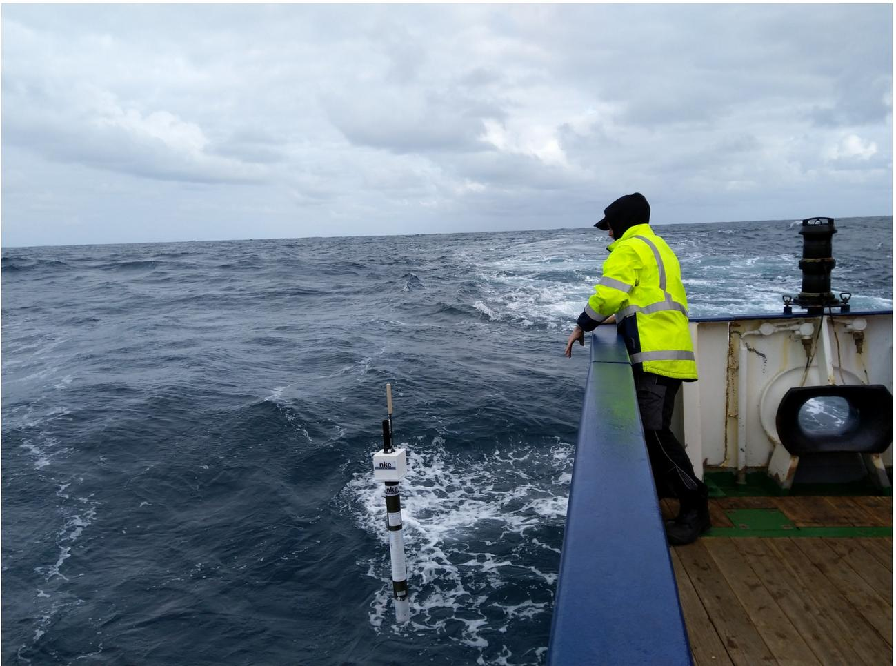
*Ein Argo-Tiefendrifter wird ausgesetzt. Foto: K. Wiegand.*
