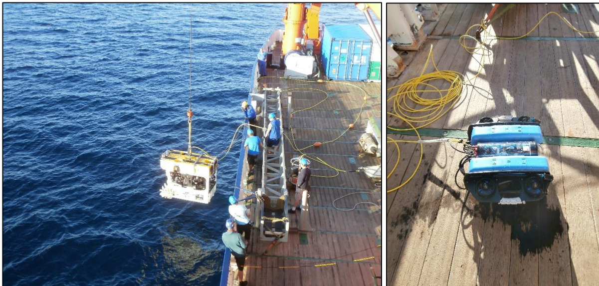
Abbildung 2: ROV SQUID wird ausgesetzt, b) „BlueROV“ an Deck nach dem erfolgreichen Test
