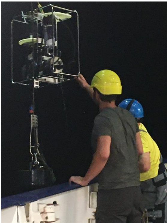
Ein In-Situ Pumpe kommt an Bord.
