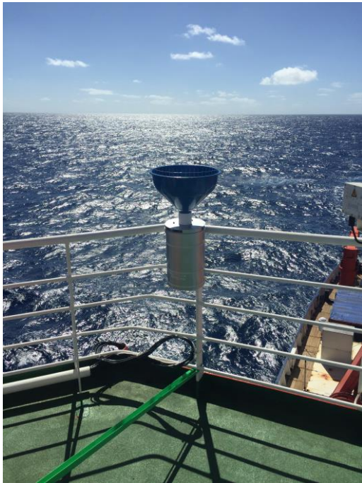
Der Regensammler der UNM (links) und das Isotopenanalysegerät im Luftchemielabor des FS Meteor .
