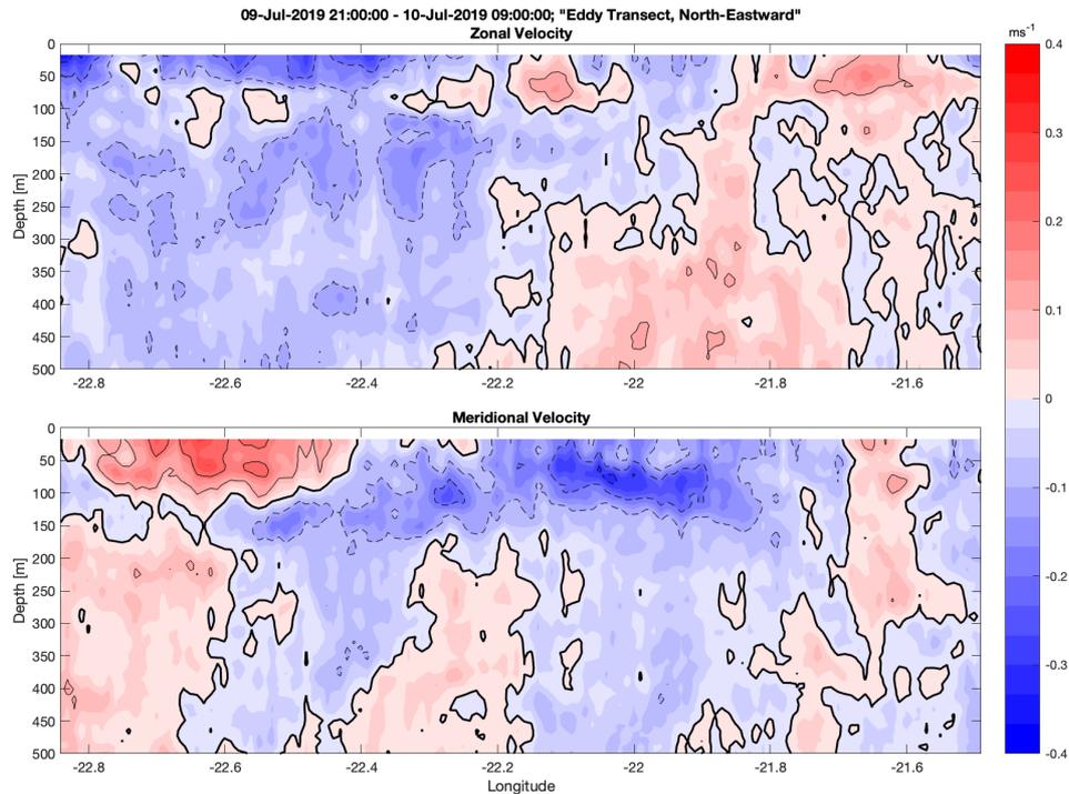
**Abb. 3:** Vertikalschnitt der zonalen (oben) und meridionalen (unten) Geschwindigkeit in den oberen 500m entlang des METEOR-Schnitts für den Zeitraum 09.07. 21:00 und 10.07. 09:00 (siehe Abb. 2 für eine geographische Darstellung). Positive Geschwindigkeiten sind ostwärts (obere Abb.) bzw. nordwärts (untere Abb.) gerichtet.
