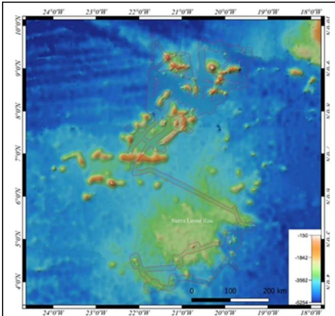
Abbildung 1: Das rote Polygon umrahmt die mit dem Multibeam vermessene Fläche von knapp 50,000 km<sup>2</sup> (erstellt von M. Schade).
