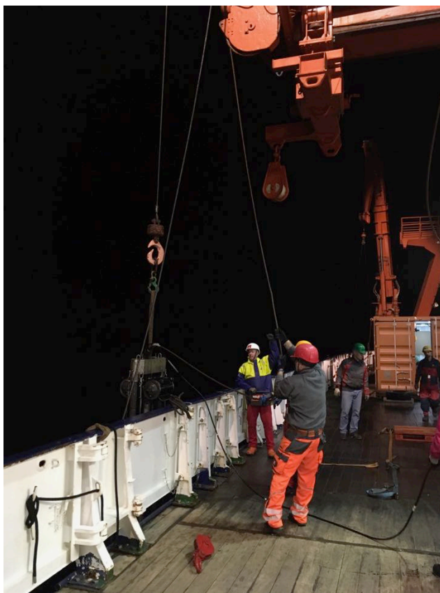
Nach der Beprobung des Meeresbodens kommt der Vibrocorer an Bord zurück
