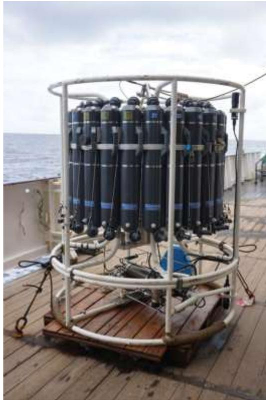
Abbildung 1: Kranzwasserschöpfer mit montierter CTD-Sonde. Foto: B. Springer.
