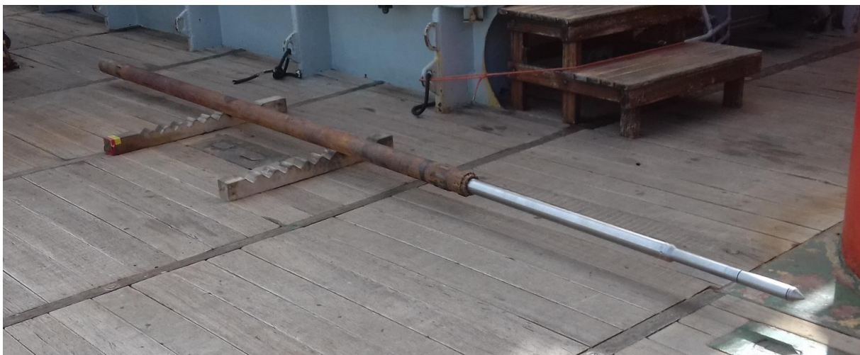
Abb. 1: Konfiguration des Bohrgestänges mit Drucksonde.
