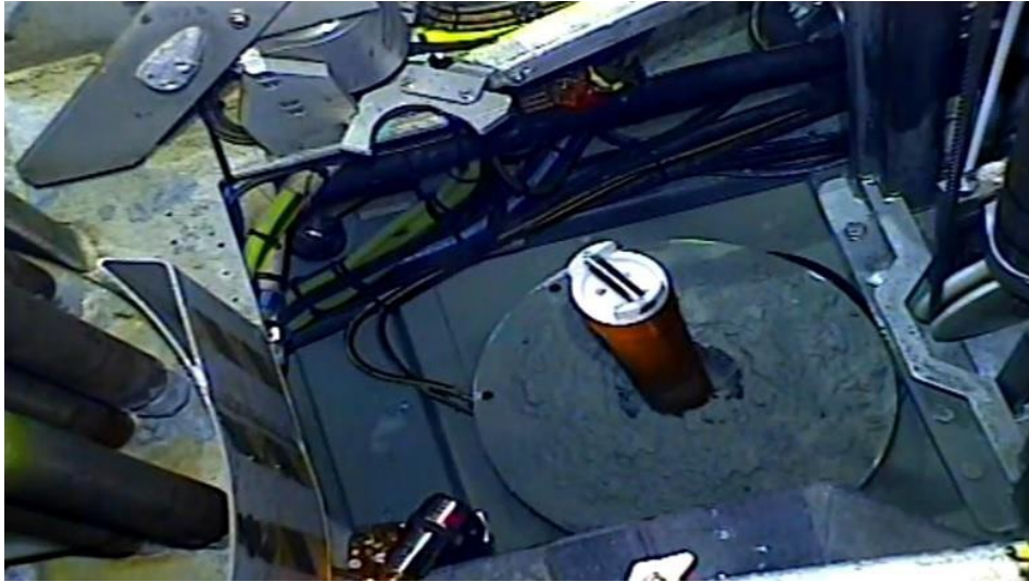
Abb.2: Eines der Langzeitobservatorien verschließt das Bohrloch am Gipfel des Schlammvulkans „Ginsburg“.
