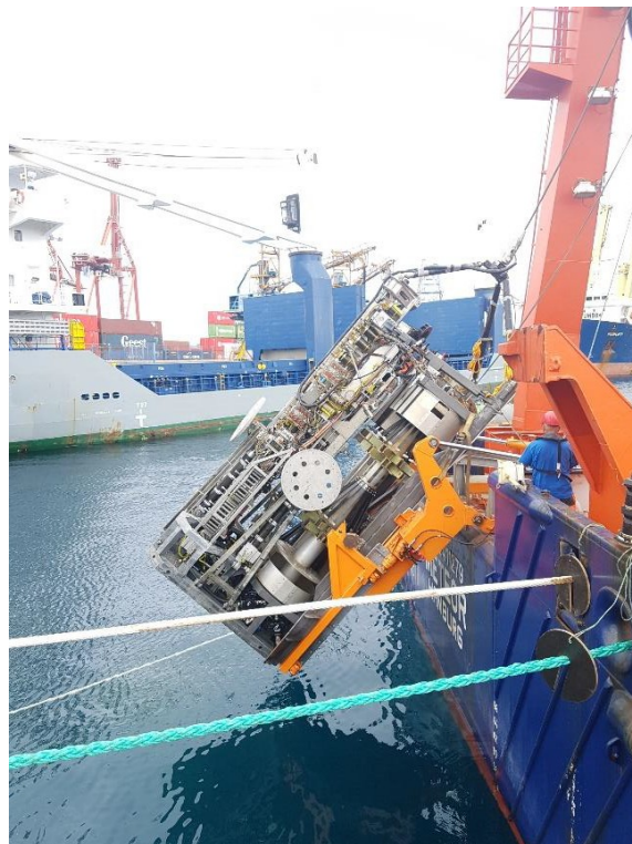
Abb. 2: Test des Meeresbodenbohrgerätes MeBo im Hafen von Las Palmas, bei dem wesentliche Funktionen des Gerätes geprüft werden ohne jedoch das Gerät auszusetzen.
