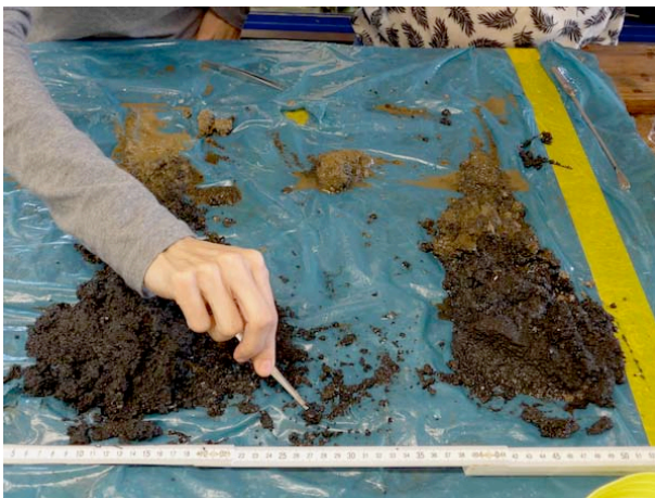
Links: Mit dem Backengreifer geborgene basaltische Asche und Lapilli. Rechts: Schwerelot-Kern mit grauer grobkörniger Aschelage, die für Schwerelot und Wärmelanze fast undurchdringlich ist.
