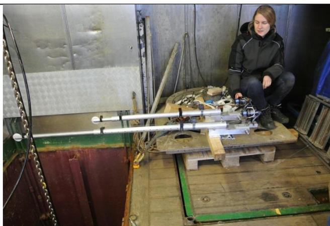
Abbildung 2: Teil des Aufbaus während der Kalibrierung des EK80. Eine Kalibrationskugel wird durch den Lotschacht (links zu sehen) mit Hilfe von Angelschnüren kontrolliert auf eine Tiefe von 8-10 m unterhalb des Schwingers positioniert (im Foto zu sehen: Mareike Kampmeier). [Foto: Line Hähnel]
