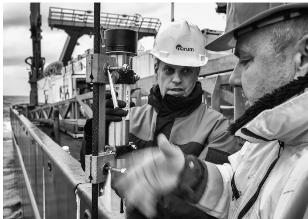
Abbildung 4: Um eine präzise Unterwassernavigation bei der Plazierung aller Geräte auf dem Meeresboden durchzuführen, nutzen wir das borgeigene Posidonia-System. Thomas Pape bringt mit Schiffsmechaniker Henry Schabeck den Posidonia Transponder dazu am Schiffsdraht über dem Schwerelos an.
