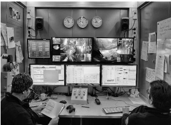
Abbildung 1: Vom Kontroll-Container aus wird das MeBo200 von 2 Operateuren eingesetzt. Mit Hilfe der Daten- und Videoübertragung vom Bohrgerät steuern Werner Schmidt und Adrian Stachowski den Bohrvorgang am Meeresgrund (© M. Beims).
