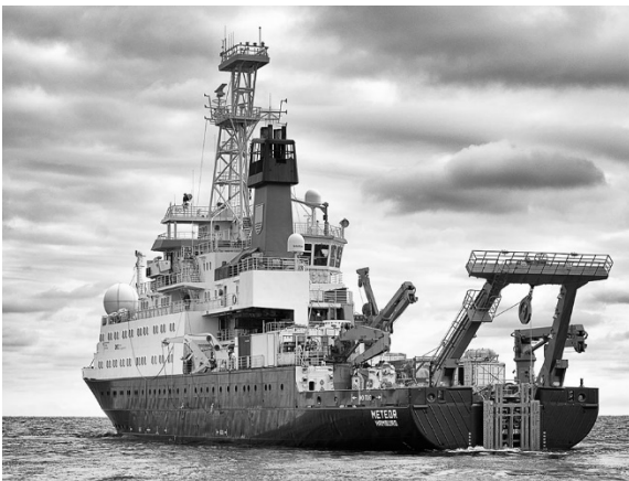
Abbildung 3: Wenn das Meeresbodenbohrgerät im Einsatz ist, verbleibt das Schiff für 2-4 Tage an gleicher Stelle. Nur das Kabel, welches über den A-Rahmen ins Wasser reicht und das Launchingsystem am Heck verraten den MeBo-Einsatz (© M. Beims).
