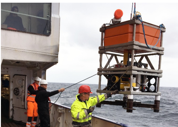
Abbildung 1: Der Gas-Lander wird vor seinem Einsatz am Schiffsdraht zu Wasser gelassen und einem Schwimmtest unterzogen.
