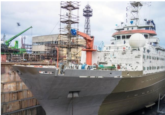
Abbildung 1: Forschungsschiff METEOR im Trockendock der Werft in Varna. Nachdem der Rumpf des Schiffes im Sandstrahlgebläse bis auf den nackten Stahl gesäubert war, wurde eine Bronze-Grundierung aufgetragen (© Heike Dugge).
