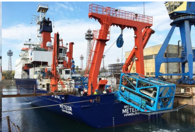
Abbildung 2: FS METEOR nach neuem Anstrich im gefluteten Dock der Odessos Werft. Nach Aufbau des MeBo200 auf dem Arbeitsdeck wurden Funktionen des MeBo im Dock getestet; unter anderem wurde das Bohrgeräte auch zu Wasser gelassen.
