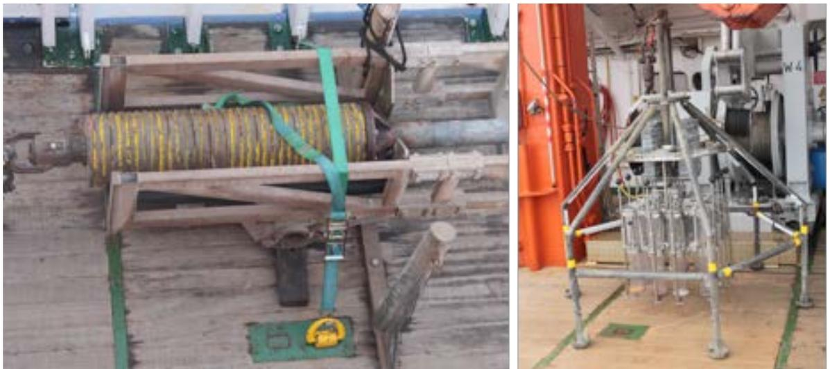
**Abb. 2.** Vorbereitung des Schwerelotes und des Multicorer
