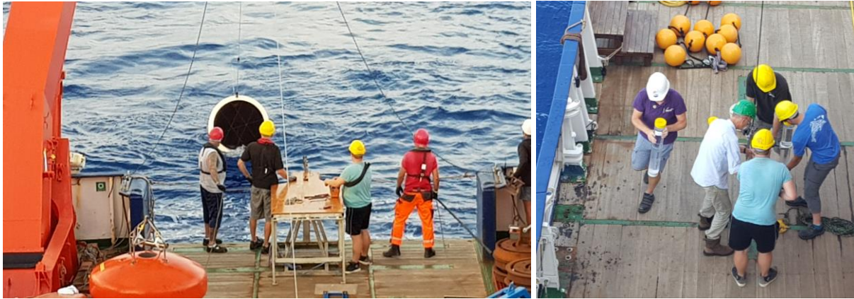
Links: Die erste Sinkstofffalle der Verankerung M3 wird über das Heck aus dem Wasser geholt. Rechts: die Entnahme der Probezylinder der driftenden Falle.
