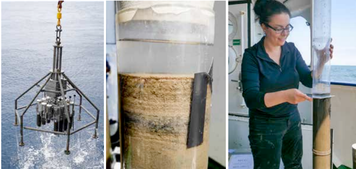
Der Multicorer kommt gefüllt aus dem Wasser. Die unterschiedlich gefärbten Schichten sind Archive der Veränderungen des Ozeans über die letzten 1000 Jahre und gut zu erkennen. Rechts Dr. Sümeyya Eroglu schneidet den Kern in 1cm dicke Schichten.
