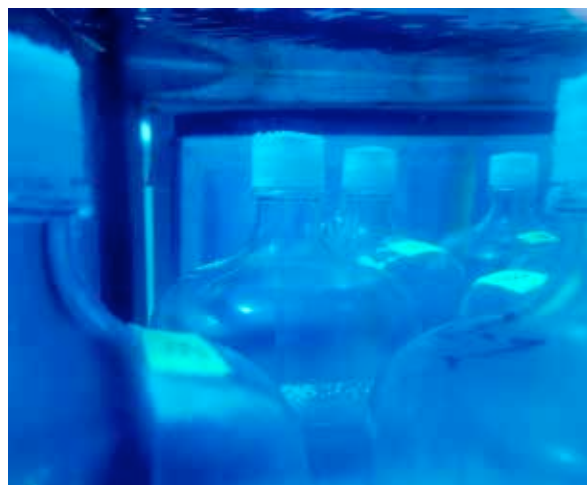
Wasserflaschen im Inkubator am Heck der METEOR werden ständig gekühlt und mit blauem Licht der Tiefsee versorgt.
