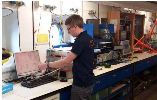
Abb 2: Im Geolabor finden die kontinuierlichen Messungen klimarelevanter Gaskonzentrationen in der Luft und im Oberflächenwasser während der Expedition M134-2 statt.
