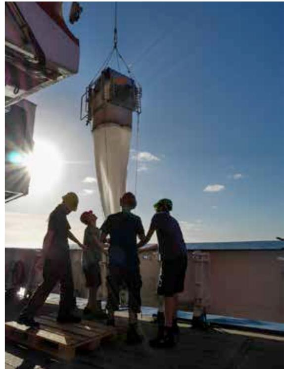
*Das Multinetz wird ausgesetzt.*
