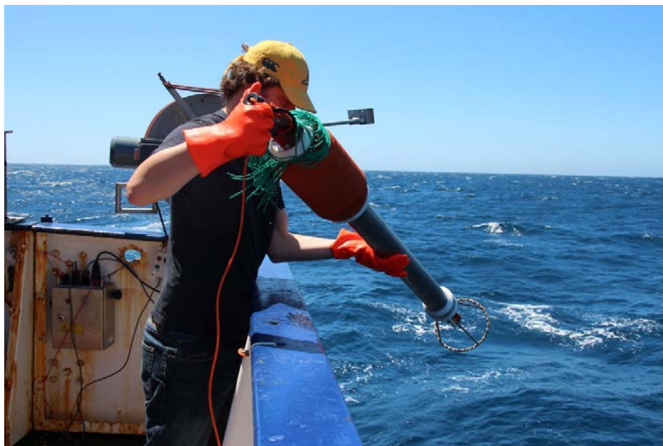
Abb. 1: Aussetzen der Mikrostruktursonde. Foto: T. Wasilewski
