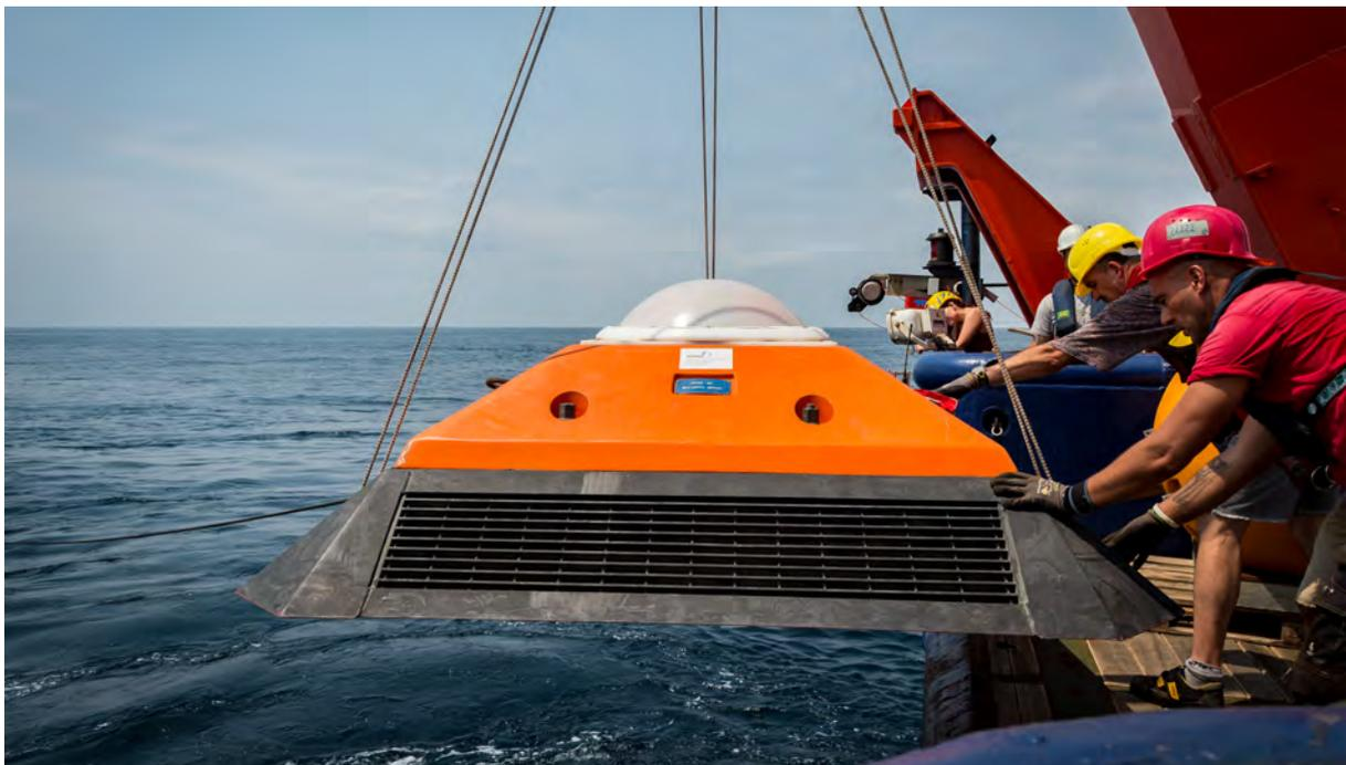
**Abb. 2:** Auslegung des Bodenschildes mit einem akustischen Strömungsmesser. Die Form des Schildes soll es vor Beschädigung durch Bodenfischerei schützen. Zur Sicherheit wurde eine Bodenleine mitausgelegt, die später auch eine Aufnahme des Schildes bei etwaiger Beschädigung des Auslösers ermöglichen soll (Foto: SvN).
