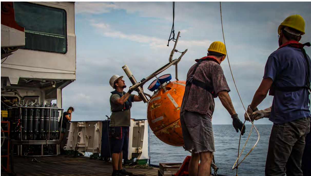
Abb. 2: Aufnahme des Kopfelements mit akustischem Strömungsmesser der Verankerung im Angolastrom bei 11°S (Foto: SvN).
