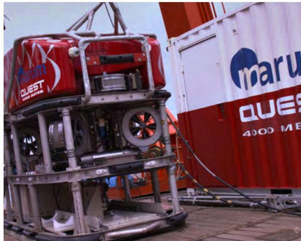
Links das ROV MARUM-Quest, rechts der Kontrollcontainer aus dem die beiden Piloten, begleitet von zwei Wissenschaftlern, während des Tauchgangs sitzen und das ROV steuern.
