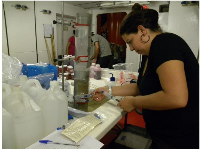
Abb. 2 Porenwasserbeprobung eines Multicorer-Kerns mittels Rhizon durch Rut Diaz (Universität Fluminense, Brasilien) (Foto: A. Albuquerque)
